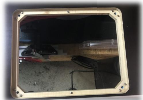
3. Anschliessend kann die Fräseinlegeplatte mittels eines 3mm Inbusschlüssels am Tisch der GTS10xc justiert werden
