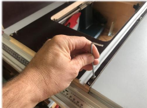
4. Jetzt die Sauter Einlegeplatte einlegen, justieren und befestigen.
