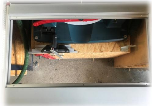
2. Vor dem einlegen der FRE-GKF müssen von der Unterseite her die 10 Stk 15x6mm Stiftschrauben in jeweils den äußeren Löchern der Ecken und in die beiden Löcher der langen Seite geschraubt werden.
